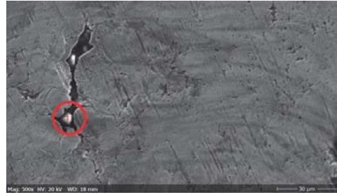
a) Szemcsehatár üregbe ékelődött Al_2O_3 szemcse (SEM felvétel)
