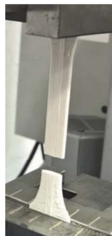
6. ábra Állított pozícióban nyomtatott próbatet, mely egyenletesen, a réteg mentén elszakadt, jelentős kontrakció nélkül
