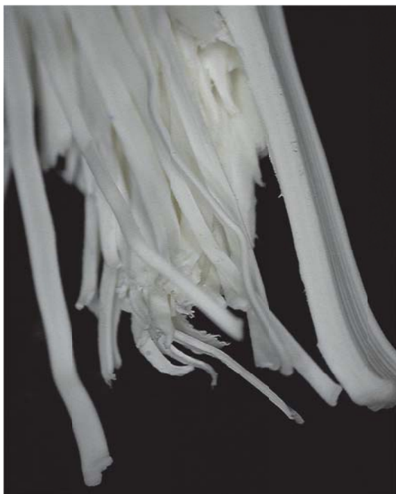
7. ábra Fekvő pozícióban nyomtatott próbatest, szakadása
