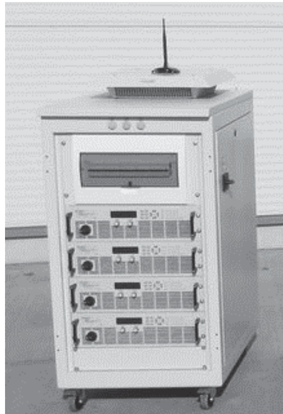
10. ábra. A 60kW-os számítógépről állítható DC tápegység.
