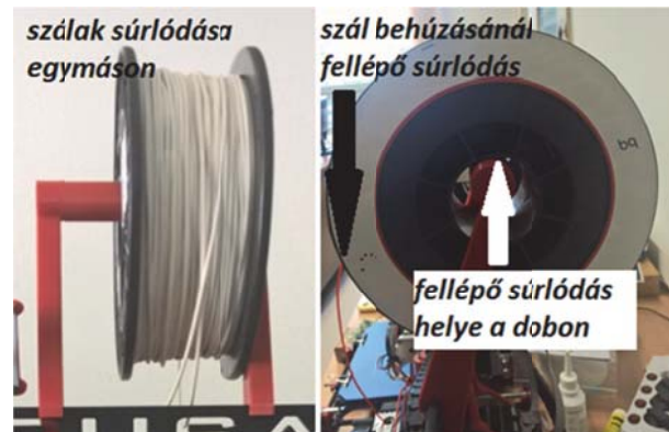
1. ábra A dobra csévélt anyag, valamint a fellépő súrlódásnak a helyei
