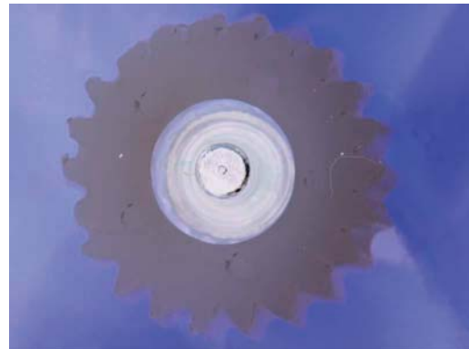
3. ábra: fogaskerék károsodása visszaforgatáskor (20x nagyítás)
