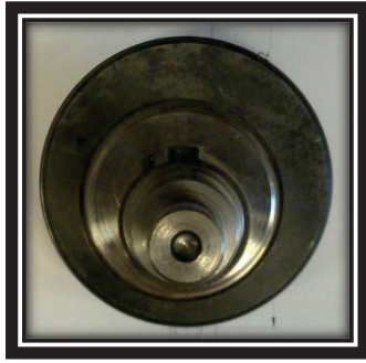
4. kép. A kivitelezett kettős excenter tárcsa szemből nézve
