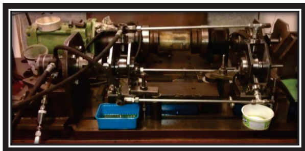
1. kép. A doktori témában elkészült Szinkronrendszerű váltakozó áramú hidraulikus hajtás kísérleti berendezése (merev fázisvezetékkel)
