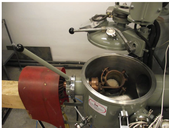
2. ábra: A hőkezelő kemence
