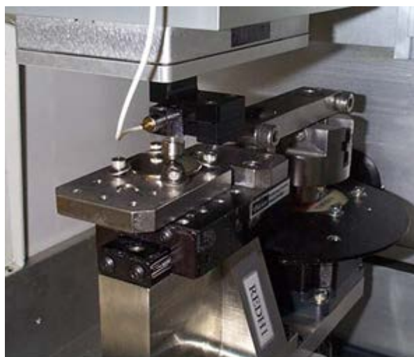
1. ábra. Lineáris alternáló mozgást megvalósító tribológiai elrendezés az UNMT-1 berendezésben
