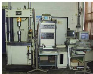
MTS 810 típusú elektrohidraulikus anyagvizsgálógép
