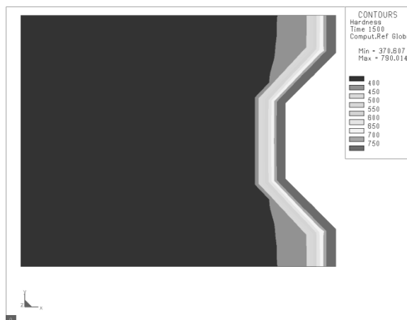
8. ábra. 18CrNiMo7-8 anyagminőségű acéltest keménységeloszlása betétedzést követően
