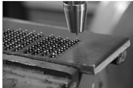
5. ábra Gömb kialakítású hegesztett szög. Szabad huzalhossz: 13.6 mm korrekció 3.
