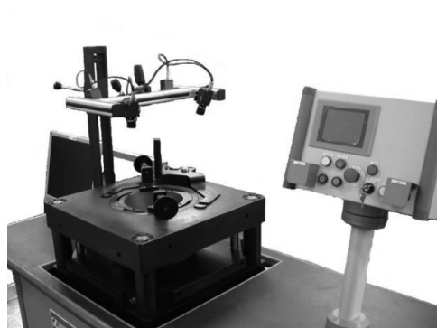
5. ábra. Vialux optikai mérőrendszerrel felszerelt univerzális lemezalakító berendezés
