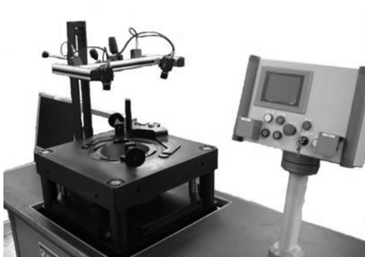
2. ábra. Az univerzális lemezvizsgáló berendezés az optikai mérőrendszerrel
