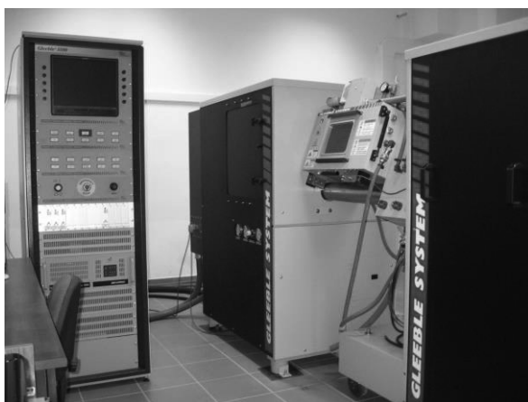
1. ábra. A Gleeble 3500 termo-mechanikus fizikai szimulátor a Miskolci Egyetem Mechanikai Technológiai Tanszékén.
