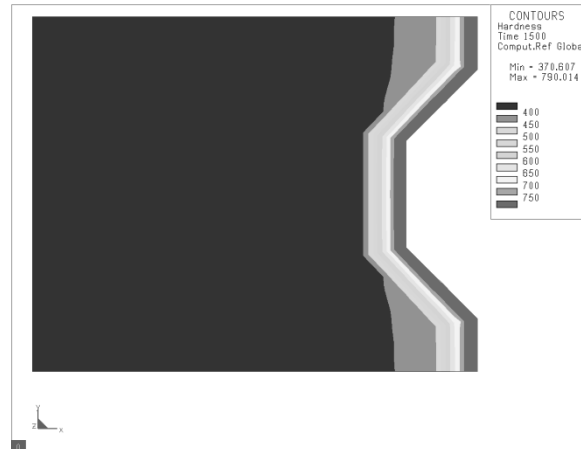
8. ábra. 18CrNiMo7-8 anyagminőségű acéltest keménységeloszlása betétedzést követően
