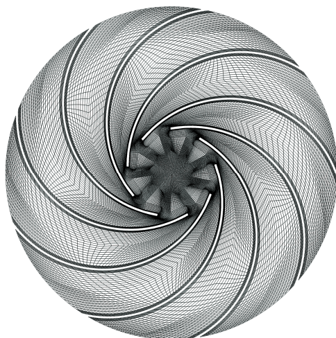
9. ábra. A 8. ábrán bemutatott járókerék teljes három-dimenziós blokk-strukturált hálójának hátsó síkja
