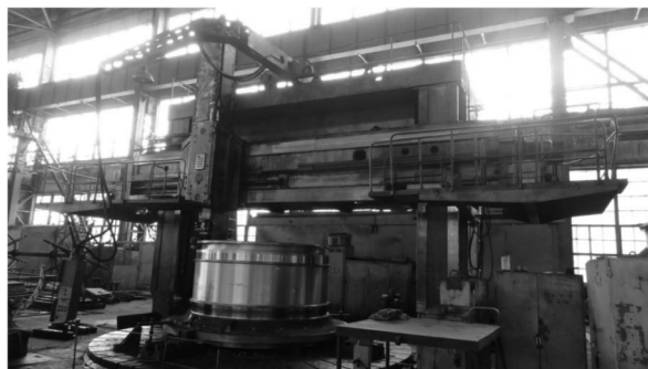
1. ábra. VTL 6300 típusú karusszeleszterga berendezés
