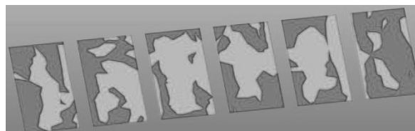
12. ábra. Az érintkező felületek F_t = 20\text{ kN} ( M_t = 600\text{ Nm} ) terhelés esetén
