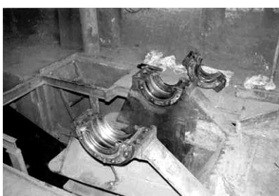
1. fénykép. Magnezittörő berendezés főtengely csapágyfészkek
