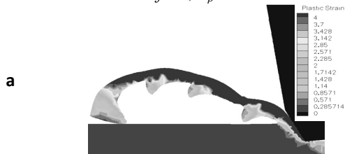
3. ábra. A képlékeny alakváltozás és a forgácsoló erő v_c = 120 m/perc, a) f = 0.1 mm/ford, a_p = 0.1 mm b) f = 0.1 mm/ford, a_p = 0.2 mm esetén
