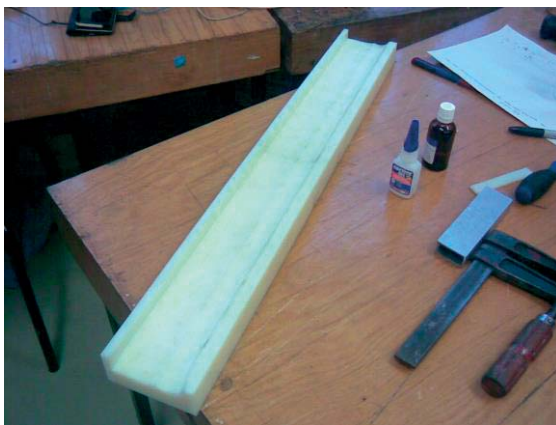
16. ábra. Az összeragasztott fényezővályú
