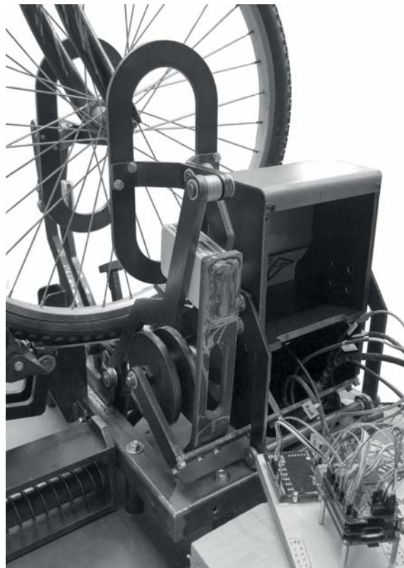
2. ábra. A zárkonstrukció a kiemelt elektronikával
