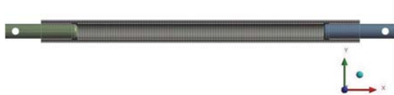
3. ábra. A tömlő hálózott geometriája hosszszelvényben
