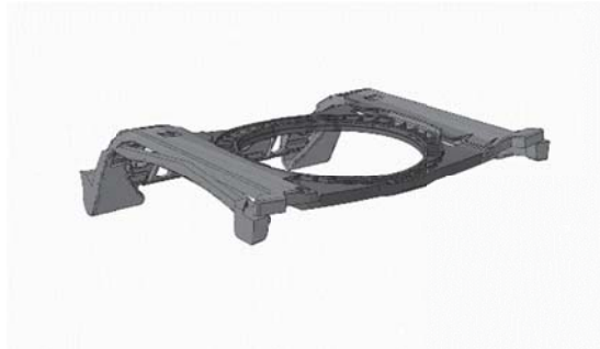
5. ábra. Az összekötő híd torzulása az első komponensnél
