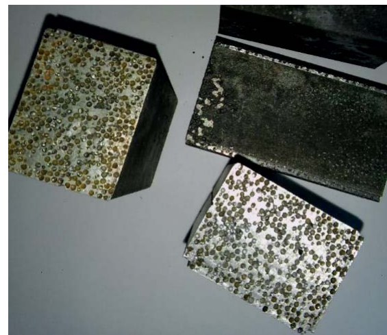
1. ábra. Fűrési kísérletre előkészített munkadarabok
