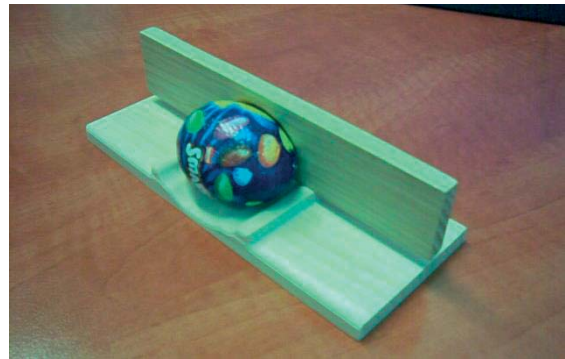
21. ábra. Gőzölt bükk anyagból készített feladó és betoló szerszámok a becsomagolt csokoládétojással együtt
