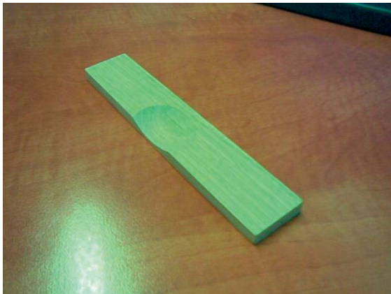
20. ábra. Gőzölt bükk anyagból készített betoló szerszám
