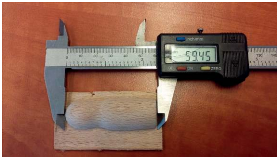
7. ábra. A módosítások nélkül legyártott mintadarab hossza
