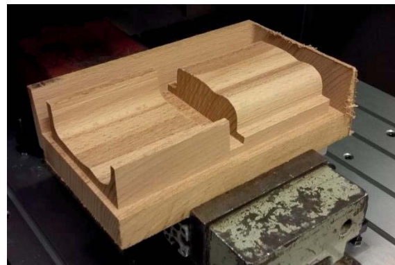
10. ábra. A vályútest próbadarab (forma és prés)
