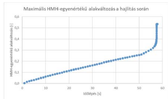
10. ábra. Maximális HMH-egyenértékű nyúlás a hajlítás során, az YZ szimmetriasíokban
