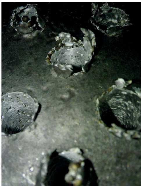
a) furatok kilépő oldalai száraz forgácsolás körülményei között
