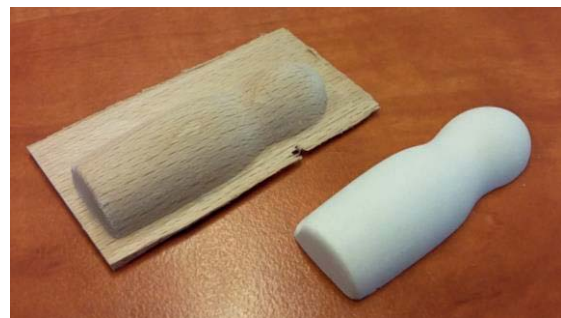
6. ábra. A Roland MDX650-el gyártott mintadarab (balra) és az eredeti gipszminta (jobbra)
