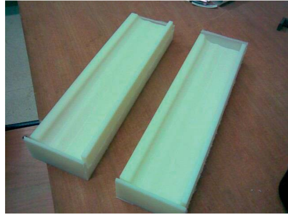
12. ábra. A PA6 anyagból készített előgyártmányok
