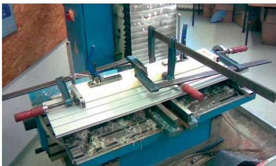
15. ábra. A vályú alkatrészek összeszorítása
