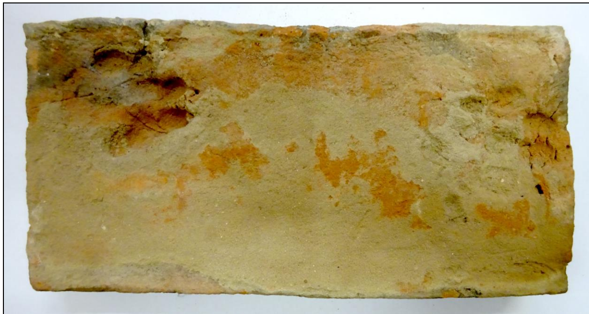
40. kép Kézivetésű téglá, amin egy eb a száradás során átkutyagolt. Az építőelem a Szív utca 16. számú egykori XVIII. század vége felé, esetleg a XIX. század elején megvalósult cívisházból származik 68
