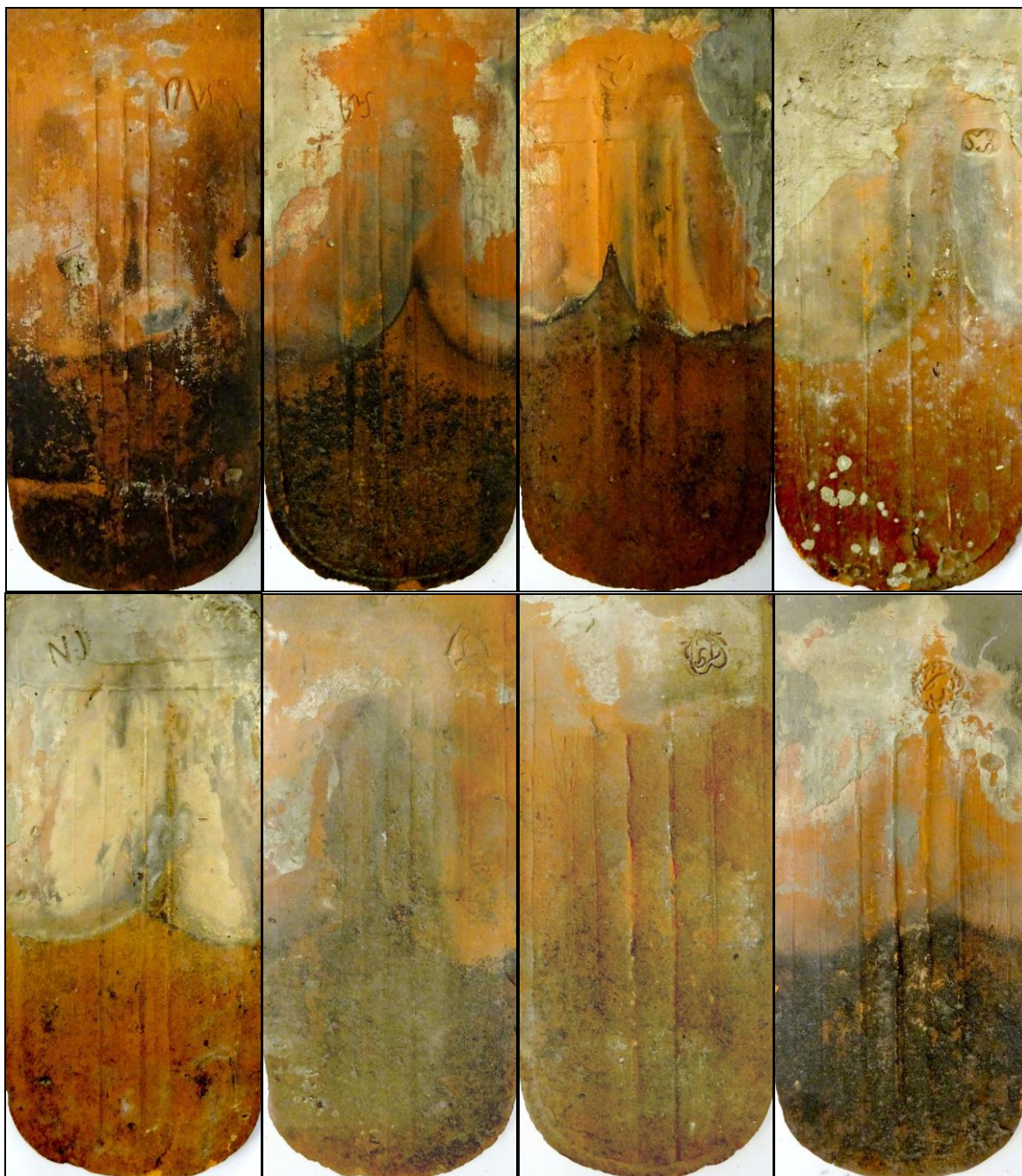
19-26. kép Debreceni hódfarkú tetőcserepek a XIX. század első feléből illetve közepe tájáról 52
