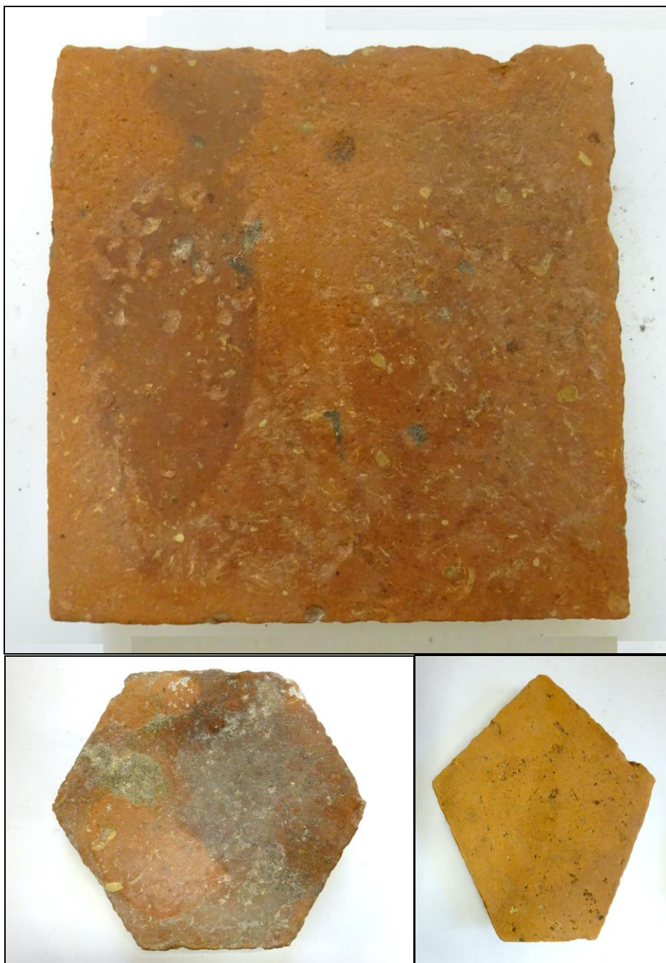
37-39. kép Emeleti padlóborítás darabja a városházáról az 1840-es évekből, illetve öt és hatszögletű padlástéglák a Somogyi kúriából. Ezek a burkolóanyagok szintén gátolták a tűz terjedését, s egyaránt esztétikusabbá tehettek egy-egy belvárosi ház kamráját, illetve szabadkéményes belsőterét is 65
