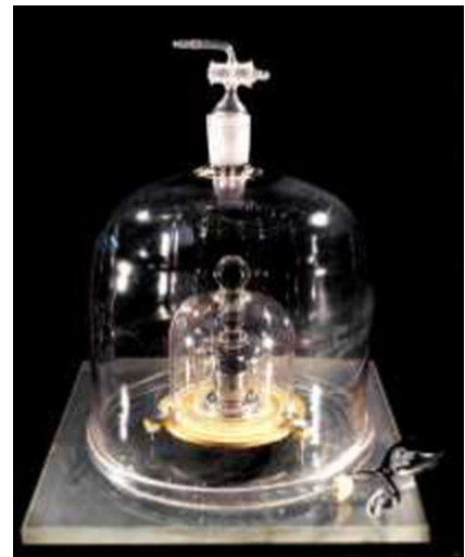
5. ábra. A nemzetközi kilogramm prototípusa három harang alakú üvegbúra alatt állandó hőmérsékleten és légnyomáson
