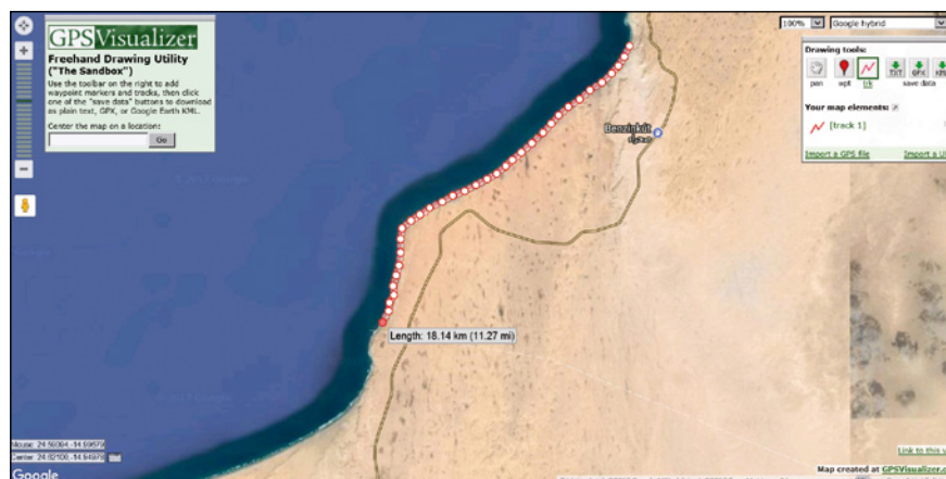
4. ábra. A GPSVisualizer interaktív weboldalán a partvonal digitalizálása
