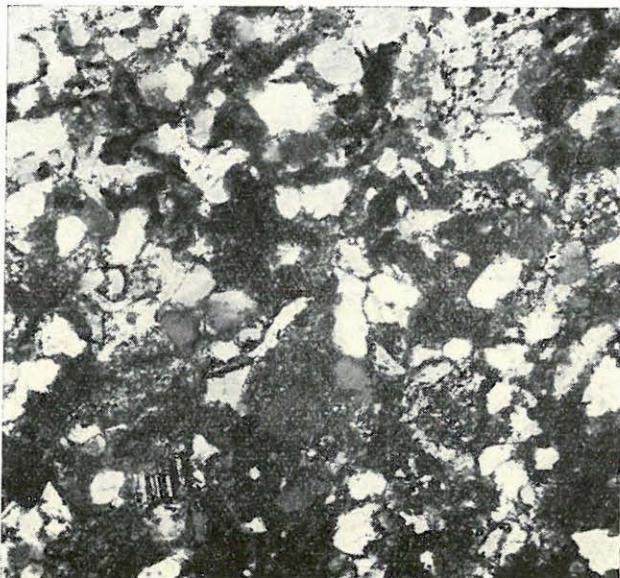
6. ábra. Középszemű homokkő, sok kötőanyaggal. Komló; a kossuth-aknai déli főkeresztvágot VI. szinti VI. és VII. kőszételep között. — Mittelkörniger Sandstein mit viel Bindemittel. Komló, zwischen den Steinkohlenflözen VI und VII des südlichen Hauptquerschlages des Kossuth-Schachtes, an der Sohle VI. + Nik. 7,5 × (Photo: PELLÉRDYNÉ)
