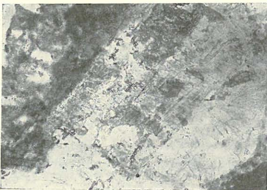
3. Kalcittal korrodált ortoklász — Durch Kalzit korrodierter Orthoklas. || Nic. 52 ×
