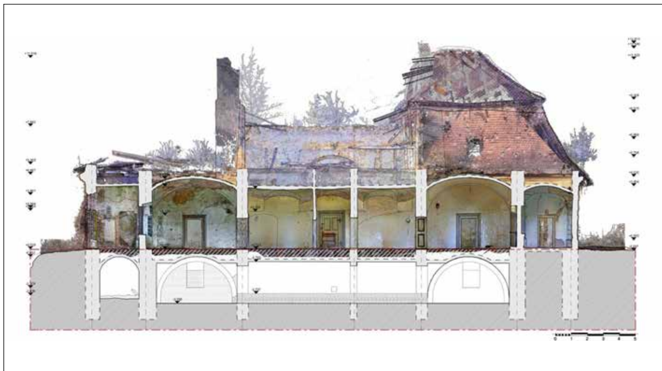
■ Fig. 4. Secțiune longitudinală și ortofoto (2020)
