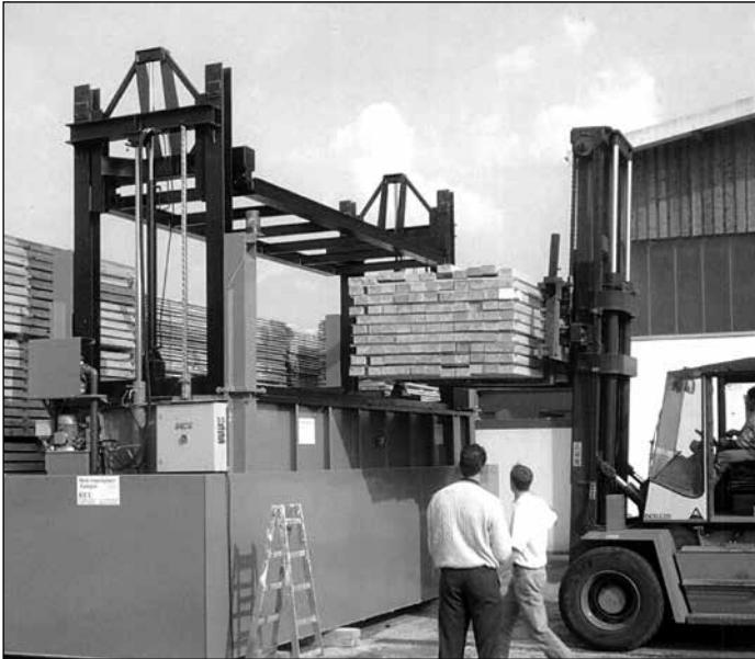
■ 5. kép: Korszerű automata vezérlésű áztatókád © Hubel ■ Photo 5. Modern automated steeping tank © Hubel
