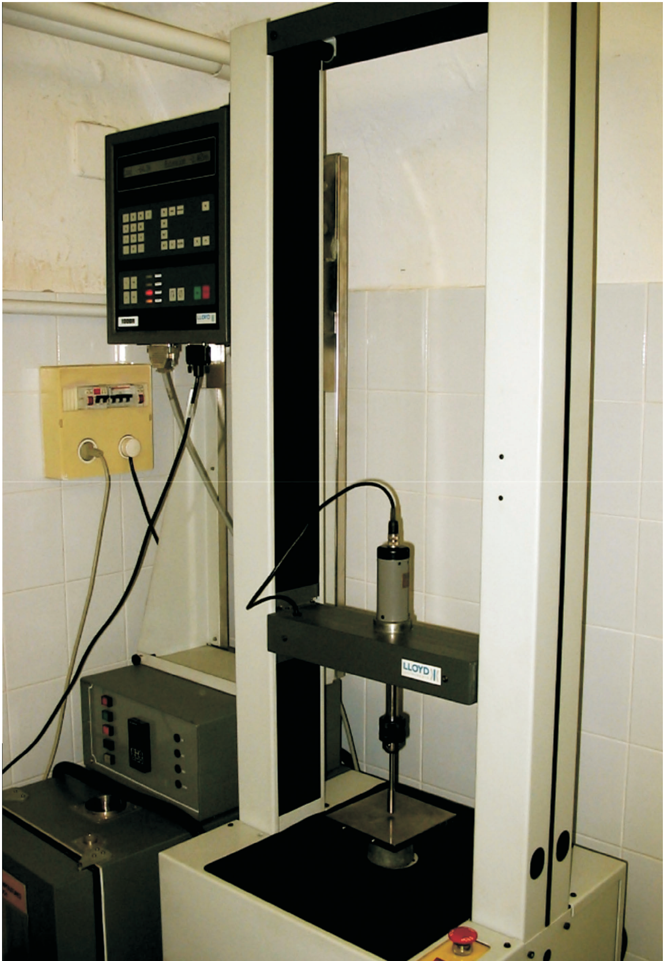
3. ábra: Lloyd 1000R típusú állománymérő készülék Figure 3.: Lloyd 1000R type texture analyser instrument
