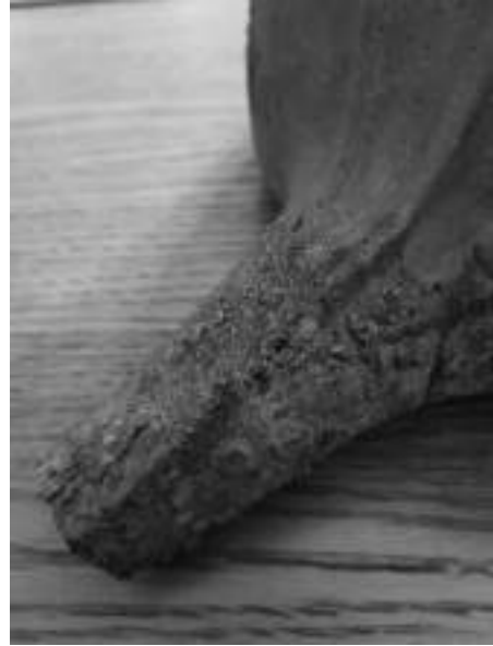
3. ábra: Az eredeti lepárló sisakjának csöve bordákkal és érdesített felülettel (A szerző felvétele, 2018)
