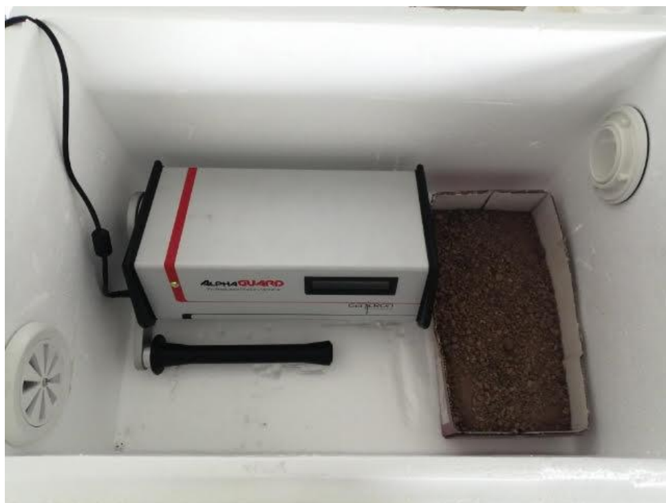
3.ábra: Radonkoncentráció mérése AlphaGuarddal a kísérleti dobozban Figure 3: Measuring radonconcentration with Alphaguard in Measuring Box
