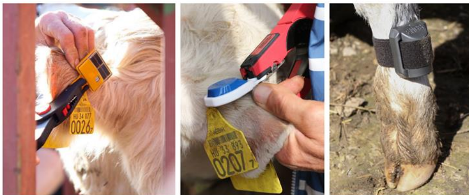
2. ábra: A borjakon alkalmazott szenzorok (GPS jeladó, fül transzponder, pedométer)
