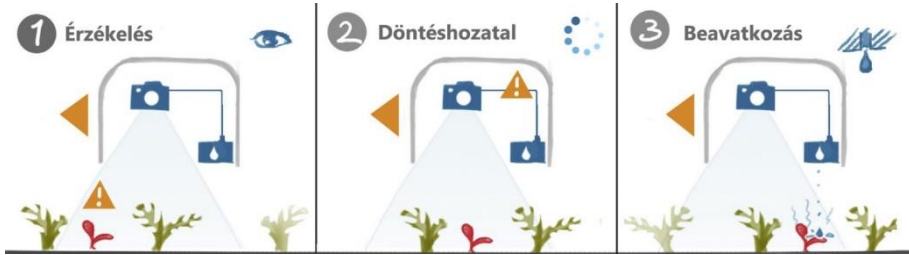
1. ábra: Egy általános célú autonóm robot-gyomirtó rendszer felépítése (Utstumo, 2018).
