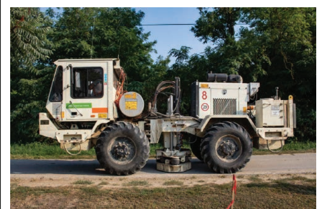
Munkatársaink ilyen önjáró vibrátor járművekkel keltenek majd mesterséges rezgéseket
