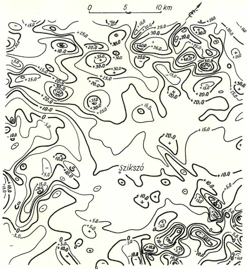
3. ábra. Szikszó környékének Constantinescu formulájával H = -1500 m-re lefelé folytatott anomáliatérképe (É-D irányú rácshálózat alkalmazásával) izovonalak értékköze: 5 mgal
