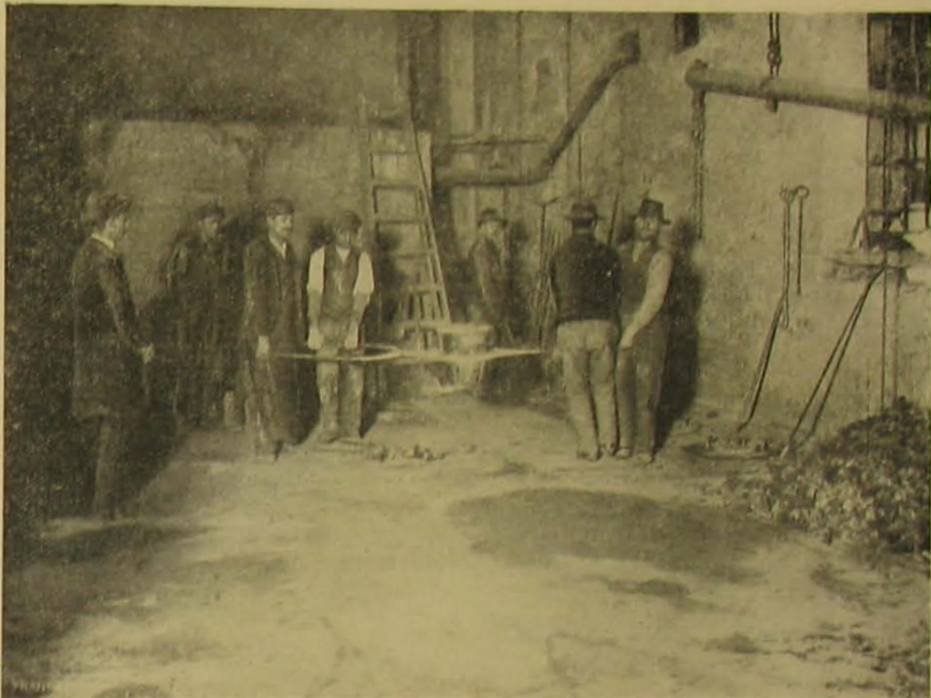
Az olvasztott bronzet graphit-tégelyben a súlyasztó gödörben levő formába hoz visszük.
