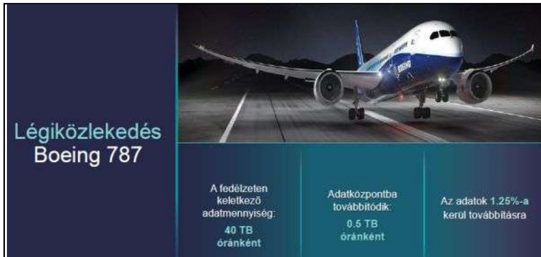
1. ábra Egy Boeing-787-es repülőgépen óránként 40 TB adatot generálnak a különféle szenzorok. Ezt költséges lenne vezeték nélkül továbbítani és valós időben feldolgozni
