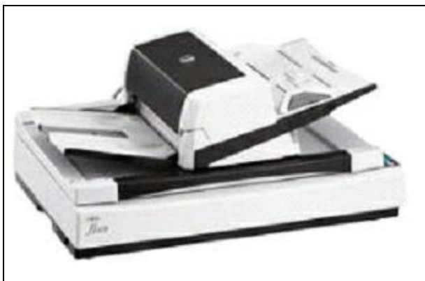
11. ábra Automata lapadagolós lapolvasó berendezés képe
