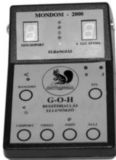
1. ábra: A GOH beszédhallást szűrő eljárás és készülék
