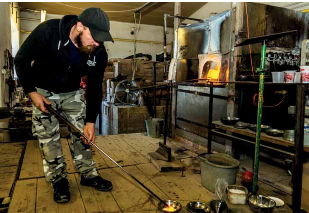
A kívánt színnek megfelelően zajlik a nyers üveg fém-oxidba hempergetése
