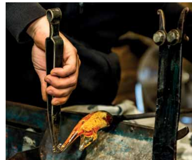
Hattyúnyak-húzás Ekkor – pláne csipesszel való munka során – már nem visszavonhatók a műveletek
