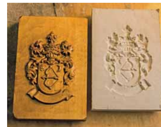
VICE VERSA A CÍMERT ELŐSZÖR FAFARAGÓ KÉSZÍTI EL – POZITÍV MINTAKÉNT, AMIRŐL GIPSZET ÖNTENEK – NEGATÍVVÁ VÁLTOZTATVA AZ EREDETI FORMÁT. A NEGATÍV FORMÁBA MÉHVIASZ KERÜL, ÉS ISMÉT POZITÍVKÉNT JELENIK MEG AZ ÁLHARANGRA KERÜLŐ CÍMER
