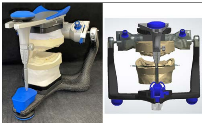
13. kép: Artikulátorban rögzített állcsont-reláció digitalizálása
