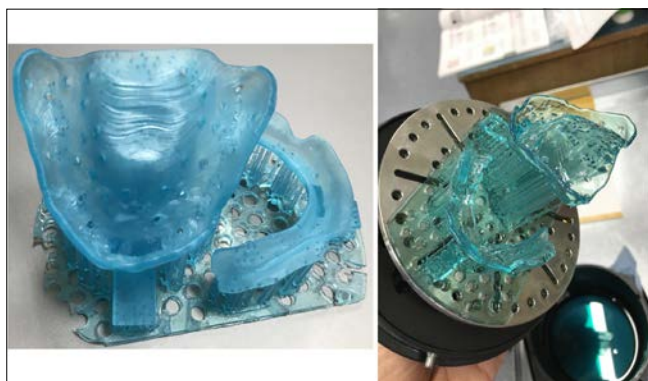
5. kép: Egyéni kanál nyomtatása fűrészalapon készítésére alkalmazott anyagból
