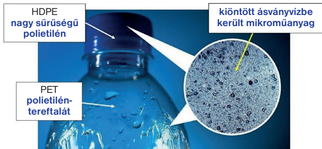
5. ábra. PET palack és kupakjának mikroműanyag szennyezése
