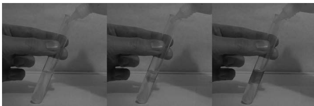
Abb. 3 - Beobachtung: Bei Zutropfen der Wasserstoffperoxid-Lösung entsteht eine gelborange Färbung.
