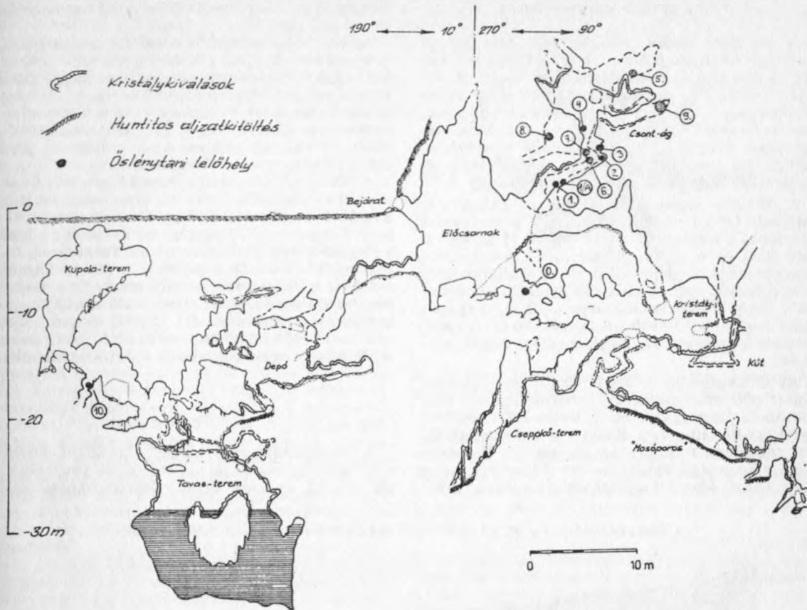
3. ábra. Beremendi-kristálybarlang. Vetített hosszmetset az A_1-A_2-A_3 vonalak mentén. Felmérte KVI-BTO. Szerkesztette: Kárpát József
