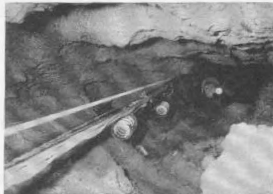
2. kép. Szondák telepítése 10 méteres mélységben (Rónakt László felvétele)
