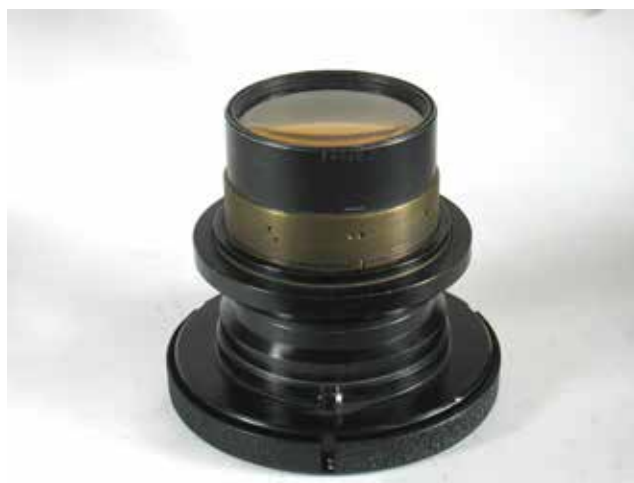
A fényképezőgépből kiserelt Aero-Ektar objektív hátsó lencsetagjain jól látható az üveg barnás elszíneződése. (A szerző felvétele.)
