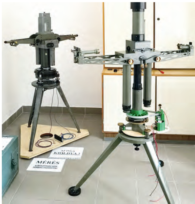
5. ábra. A mérésekre kész műszerek a BME Általános- és Felsőgeodézia Tanszékén. Balra hátul az AutERBal-, jobbra elől az Eötvös–Pekár-inga
