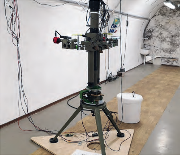
7. ábra. Az Eötvös-kísérlet újramérése 30 m mélységben a KFKI Jánosy Földalatti Fizikai Laboratóriumában az átalakított Eötvös–Pekár-ingával
