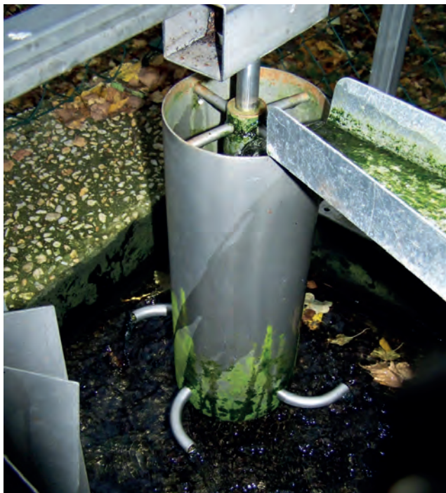
2. ábra. Segner-kerék a ziegenrücki vízenergiái múzeumban
