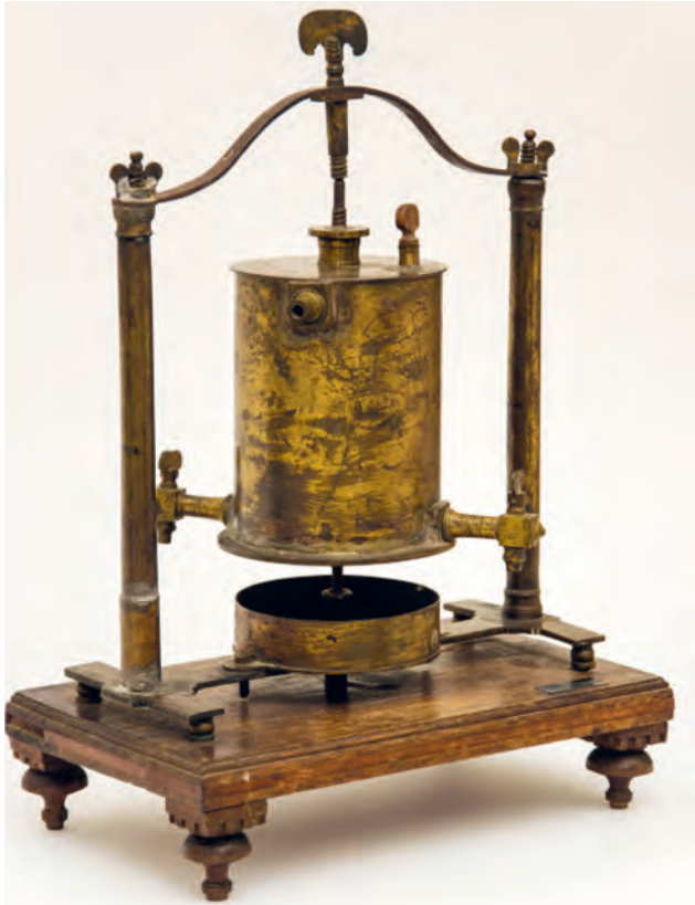
2. ábra. Demonstrációs Segner-kerék Debrecenből (Ősz Attila felvétele)
