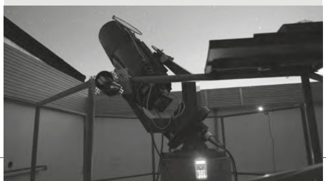
11. ábra. A távcső a hozzákapcsolt műszerekkel. Két irányban szétnyitható tető alatt helyezkedik el.
