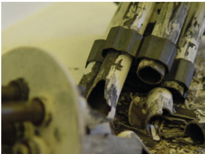
5. ábra. Ridegtörést szenvedett, oxidált, kísérleti fűtőelemköteg
