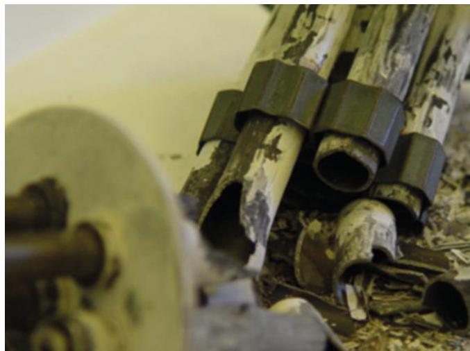
5. ábra. Ridegtörést szenvedett, oxidált, kísérleti fűtőelemköteg
