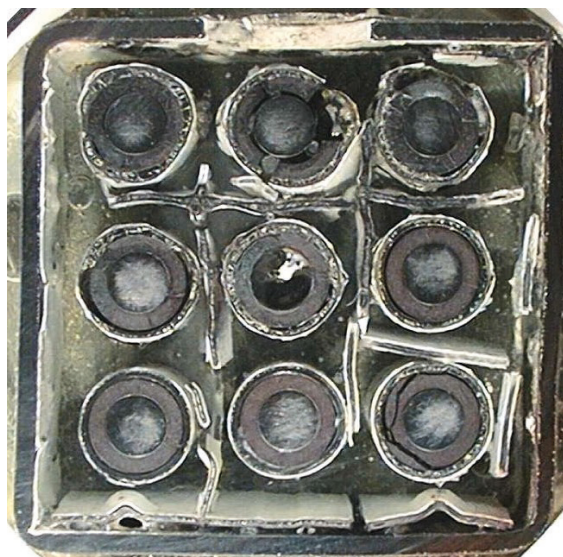
6. ábra. Kísérleti fűtőelemköteg metszete légbetöréses baleset szimulációja után
